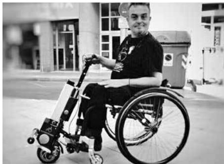
motor de menos potencia y una tercera rueda de dimensiones reducidas (125 mm.). Básicamente, este dispositivo surgió de modificar un patinete eléctrico haciéndolo adaptable a una silla de ruedas. El sistema de anclaje a la silla es similar utilizando un solo punto central por lo cual la gama de **sillas MONO** son ideales para este
