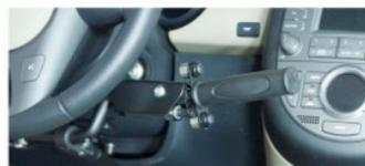
Palanca acelerador y freno
