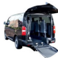
Rebaje de suelo
