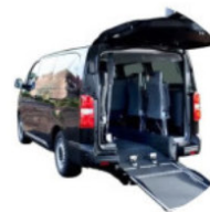
Rebaje de suelo
