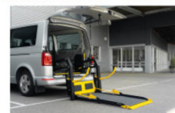
Rampa dos tramos
